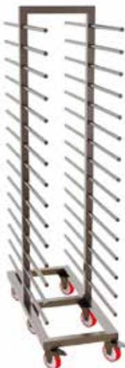
Carrello porta teglie doppio per teglie 600x400, struttura in tubolare 40x40, pioli in tubolare tondo  $\varnothing$  26. Ruote a supporto girevole  $\varnothing$  100.
