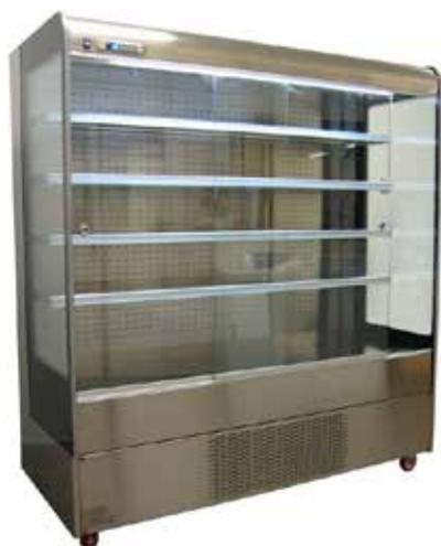
Frigo murale verticale per prodotti confezionati a refrigerazione ventilata. Realizzazione in acciaio inox aisi 304. Allestito con vasca e 4 ripiani intermedi. Illuminazione superiore. Temperatura di esercizio 0+4°C. Gruppo compressore incorporato. Centralina elettronica di controllo funzioni. Alimentazione 220v 50hz.
