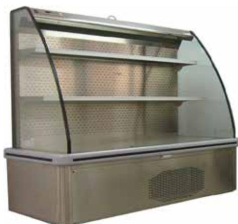
Frigo murale semiverticale per prodotti confezionati a refrigerazione ventilata. Realizzazione in acciaio inox AISI 304. Allestito con vasca e 2 ripiani intermedi. Illuminazione superiore. Tenda notte auto avvolgente. Temperatura di esercizio +4°+6°C. Gruppo compressore incorporato. Centralina elettronica di controllo funzioni. Alimentazione 220v 50 hz.
