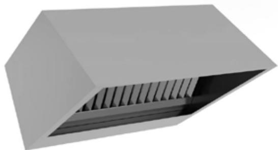
Cappa classica a parete per aspiratore remoto, in acciaio inox AISI 304 con finitura scotch brite, assemblata per puntatura, pieghe ribordate, canalina raccogli grasso con rubinetto, filtri a labirinto inox.
