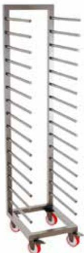
Carrello porta teglie per teglie 600x400, struttura in tubolare 40x40, pioli in tubolare tondo  $\varnothing$  26. Ruote a supporto girevole  $\varnothing$  100.
